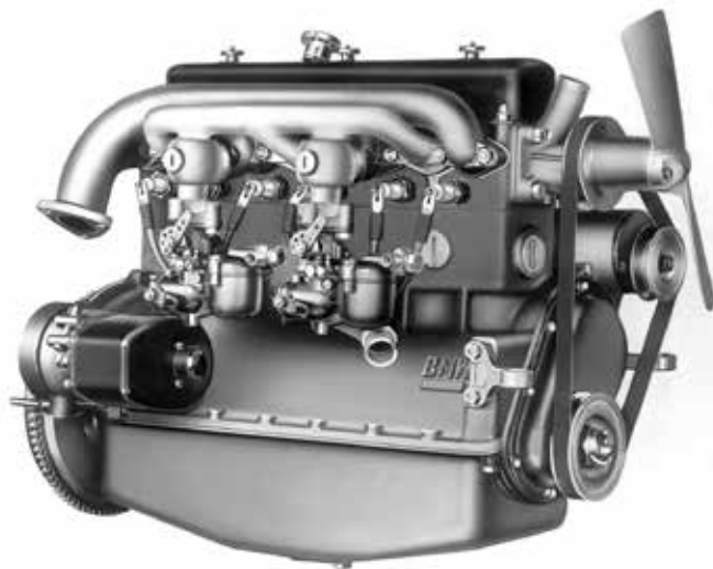
Prvi BMW – jev linijski šestvaljni motor, ki je bil vgrajen v model 303 iz leta 1933
