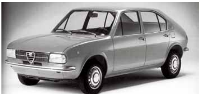
Avtomobil Alfasud, štirivaljni bokser motor z dvema odmičnima gredema v glavah, prostornine 1186 ccm, 46 kW (63 KM) pri 6000 vrt./min, 155 km/h
