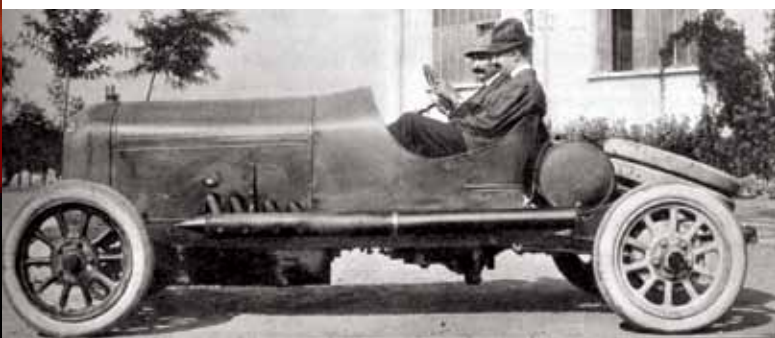
Alfa 15 HP Grand Prix, letnik 1914 z motorjem, ki ga je konstruiral Giuseppe Merosi (za volanom), z dvojno odmično gredjo v glavi motorja in štirimi ventili na valj
