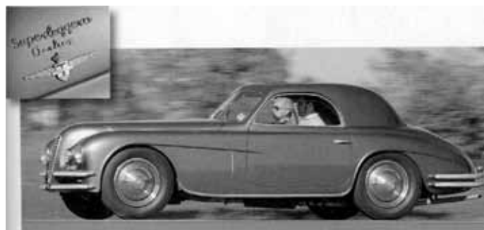
Alfa Romeo 6C-2500 Super Sport Aerlux, letnik 1947, šestvaljnik z dvema odmičnima gredema v glavi motorja in tremi dvojnimi vplinjači, moč 80 kW (110 KM), 170 km/h z napisom Superleggera Aerlux in velikim T oblikovalca Touringa na levi in desni strani pokrova motorja.
