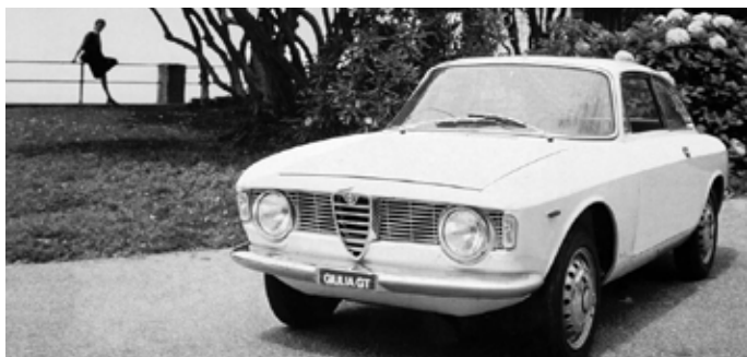
Giulia Sprint G.T., 1570 ccm, 78/106 kW/KM pri 6000 vrt./min., 180 km/h, proizv. 1963 – 1966.
