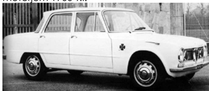
Giulia T.I. Super, 1570 ccm, 82/112 kW/KM pri 6500 vrt./min., 190 km/h, proizv . 1963 – 1964.
