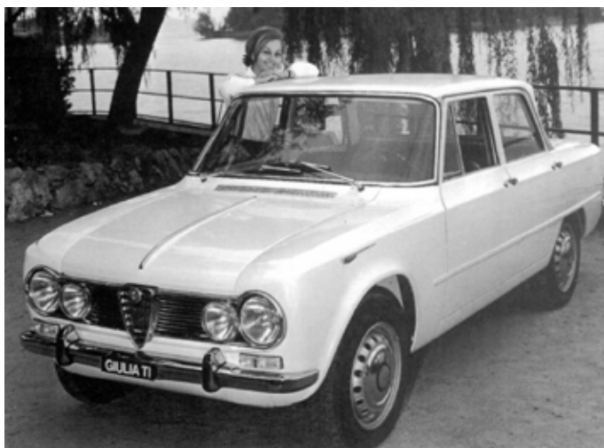
Giulia T.I., 1570 ccm, 68/92 kW/KM pri 6000 vrt./min., 170 km/h, proizv. 1962 – 1968.
