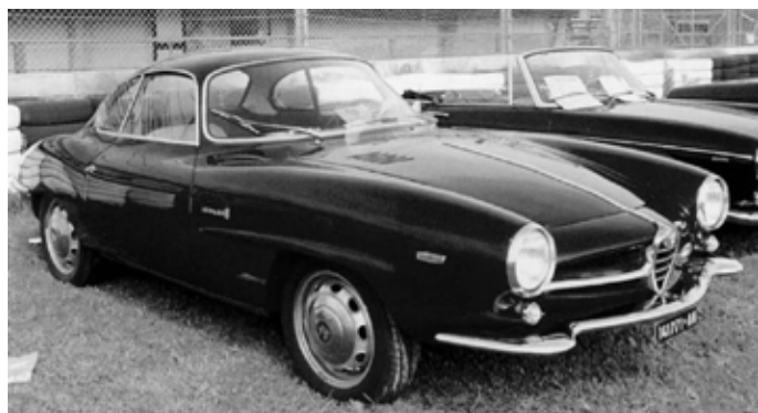
Giulia Sprint Speciale, 1570 ccm, 82/112 kW/KM pri 6500 vrt./min., 200 km/h, proizv. 1963 - 1966
