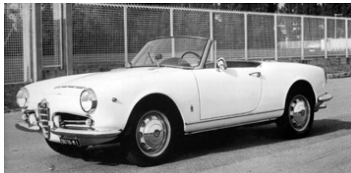
Giulia Spider, 1570 ccm, 68/92 kW/KM pri 6200 vrt./min., 172 km/h, proizv . 1962 – 1965.
