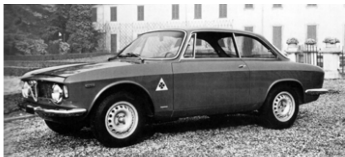
Giulia Sprint GTA, 1570 ccm, 85/115 kW/KM pri 6000 vrt./min., 190 km/h, proizv. 1965 – 1969.
