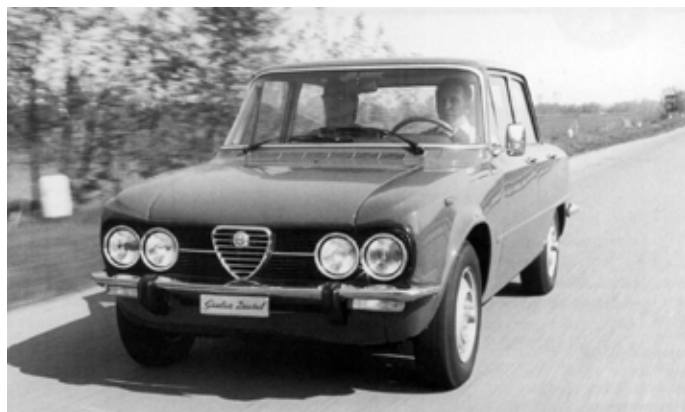
Giulia Diesel, 1760 ccm, 40/55 kW/KM pri 4000 vrt./min., 140 km/h, proizv. 1976.
