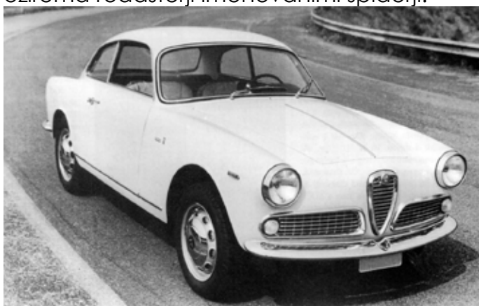
Giulia Sprint, 1570 ccm, 68/92 kW/KM pri 6200 vrt./min., 172 km /h, proizv. 1962 – 1963.
