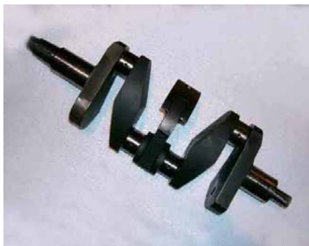
URAVNOTEŽENA IN OJAČANA ROČIČNA GRED, KI JE BILA V POSEBNI PONUDBI ZA FRIZIRANJE MOTORJA, KO JE BIL DODAN TUDI PUHALNIK COZETTE.
