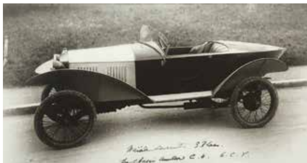
TRISEDEŽNI AMILCAR C4, SKIF KAROSERIJA »LA PHOCÉENNE« JE IZDELANA IZ MAHAGONIJEVIH LETVIC, POKROV MOTORJA IN BLATNIKI PA SO IZDELANI IZ ALUMINIJA. NA PODALJŠANEM OKVIRJU SE TRETJI SEDEŽ NAHAJA V REPU VOZILA. »VOITURETTE« NA SLIKI PRESEGA TEŽO »CYCLECAR« KATEGORIJE.
