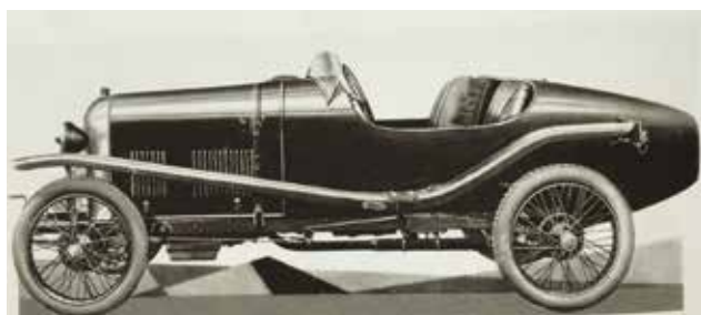
1925 AMILCAR CGS, 7CV, SLIKA JE BILA OBJAVLJENA V KATALOGU. LEPO SO VIDNI ŽLEBASTI BLATNIKI, BOBNASTE ZAVORE SPREDAJ IN ZADAJ TER ZAMAKNJENI SEDEŽI. KAROSERIJA NI IMELA VRAT NITI STREHE.
