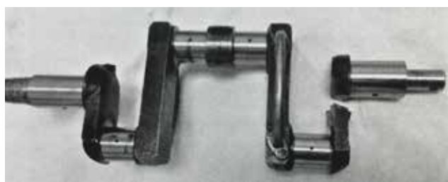
PRELOMLJENA ROČIČNA GRED 4 VALNEGA MOTORJA AMILCAR
