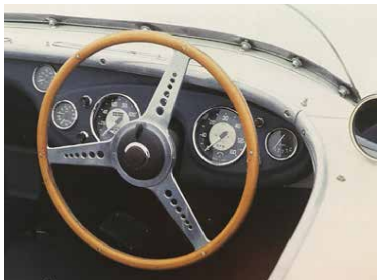
VOLANSKI OBROČ JE IZ ALUMINIJASTIH KRIŽNIH NOSILCEV, OLAJŠANIH Z IZVRTINAMI IN OBDAN Z LESENIM OBODOM. DODATNO JE NAMEŠČEN INSTRUMENT ZA MERJENJE TEMPERATURE OLJA – NA MESTU STIKALA ZA OVERDRIVE PRI OBIČAJNEM AH. MENJALNIK JE ŠTIRISTOPENJSKI BREZ »OVERDRIVE«.
