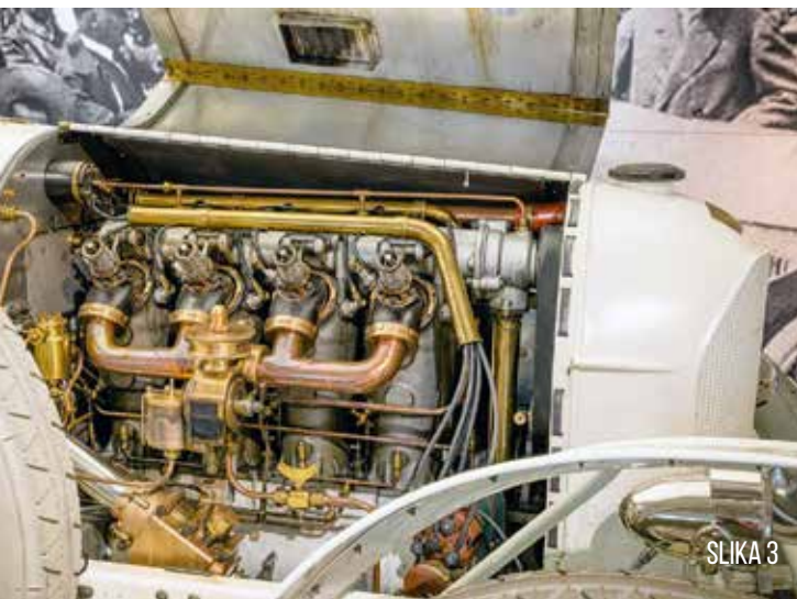
KONSTRUKTORJEVA MOJSTROVINA - POGONSKI AGREGAT AVTOMOBILA AD PRINCE HENRY, LETNIK 1910, ŠTIRJE VALJI, 5700CCM, ODMIČNA GRED V GLAVI MOTORJA, 63KW, HITROST 140 KM/URO. IZDELANIH JE BILO SAMO 12 PRIMERKOV.
