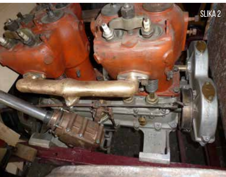
SLIKA 1 PRIKAŽUJE AD MAJA, LETNIK 1907 V GARAŽI I. KISAPATI NA MADŽARSKEM. POGON NA ZADNJA KOLESA JE IZVEDEN Z VERIGO. NA SLIKI 2 PA JE VIDEN POGONSKI 4 VALJNI AGREGAT 2X2, T GLAVA, KONCEPT DAIMLER.
