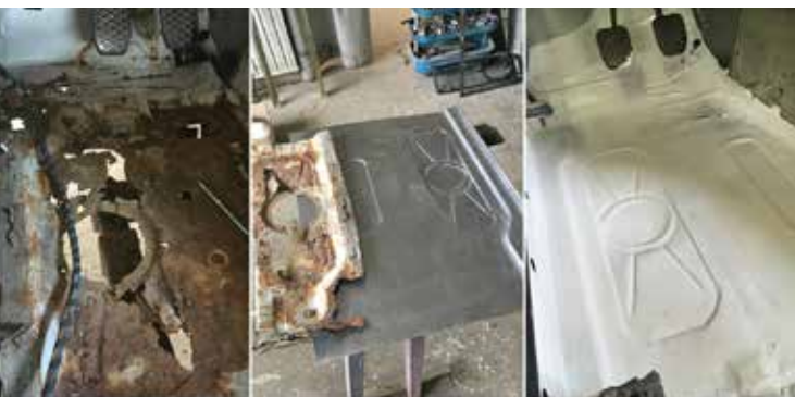
SLIKA 2: STANJE PRED POPRAVILOM, NADOMESTNA PLOČEVINA IN KONČNI IZDELEK
