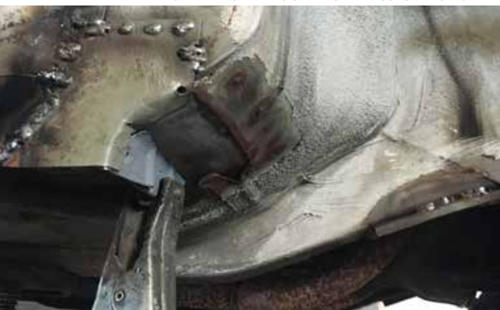
SLIKA 4: POPRAVILO STEBRIČKA NA SOVOZNIKOVNI STRANI
