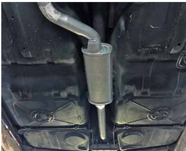
SLIKA 11: MENJAVA IZPUŠNEGA SISTEMA
