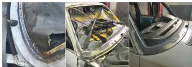
SLIKA 5: MENJAVA SPODNJEGA ROBA POD VETROBRANSKIM STEKLOM
