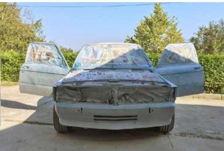
SLIKA 8: AVTO V ŠPRICKITU TER POPRŠEN Z MEGLO TEMNEJŠE BARVE ZA KONTROLO KVALITETE PRI BRUŠENJU
