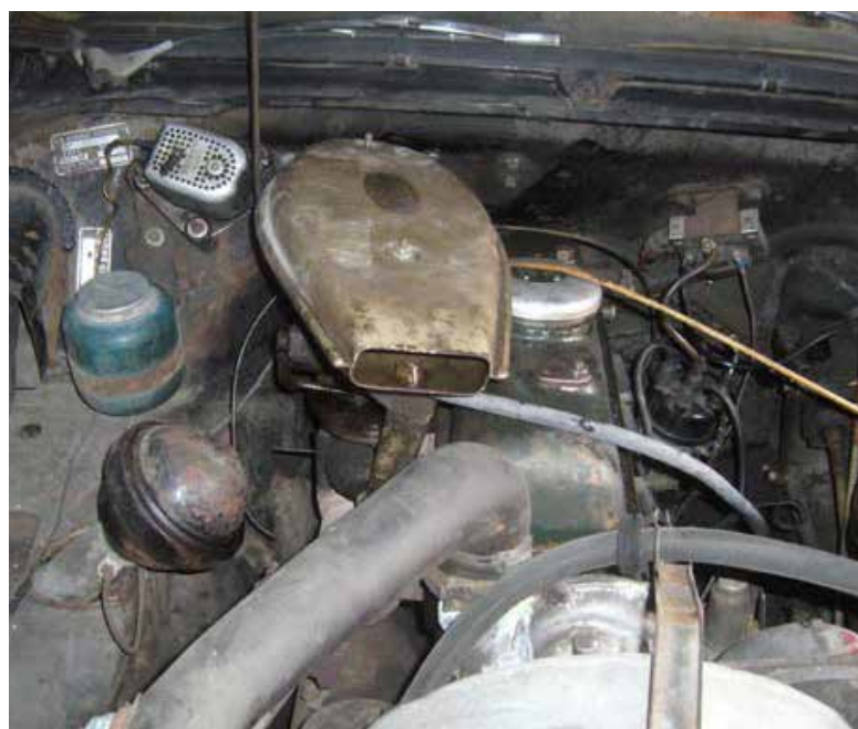
Motor modela ID 19 Normale z litoželezno glavo
