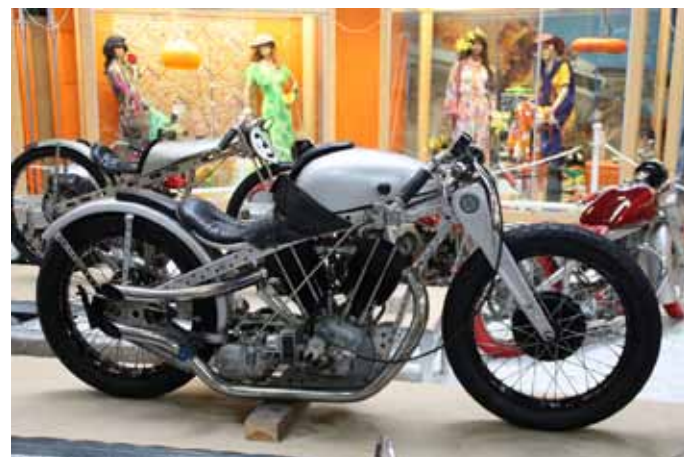
Neander z motorjem JAP KTOR V2 1000, dirkalni model iz leta 1928, okvir še dodatno olajšan
