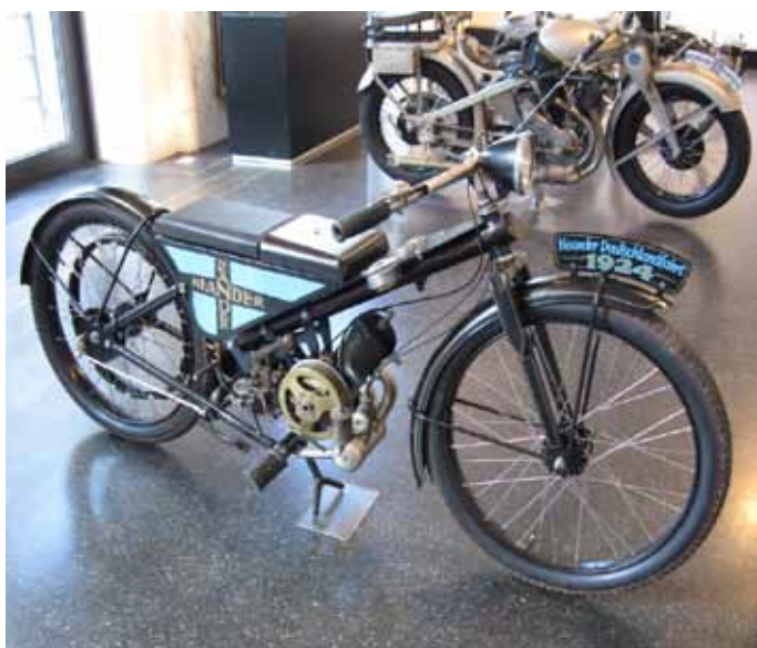
Neander "Deutschladfahrt 1924", motor Villiers 150 brez pokrova na magnetnem vžigu
