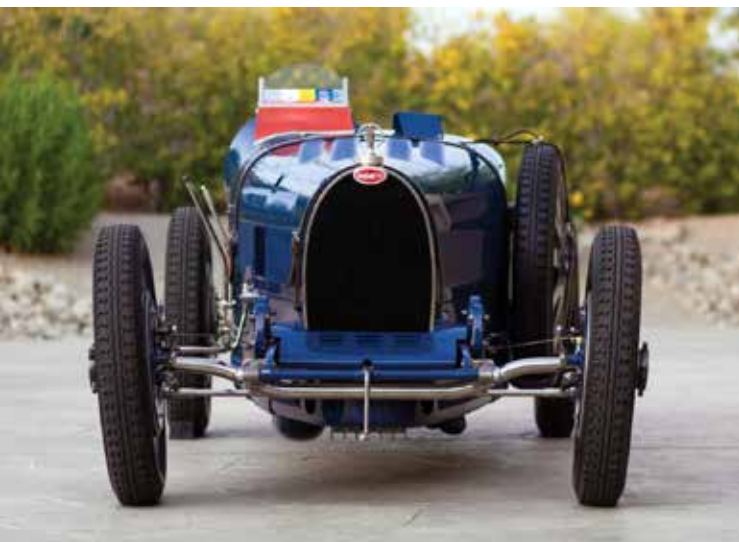
SLIKA 4. POZITIVNI CAMBER PRI VINTAGE DIRKALNIKU SPREDAJ
