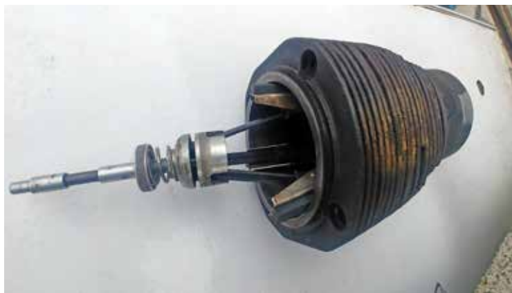
MALO POBRUŠEN (HONAN) RABLJEN CILINDER NE ŠKODI, RAZE ZA OLJE SO DOBRODOŠLE.
