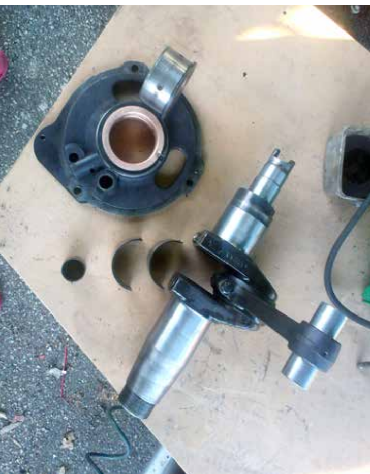
TAKOJ PO RAZSTAVLJANJU MOTORJA SEM DAL NA BRUŠENJE GLAVNE GRED Z OJNICO.
