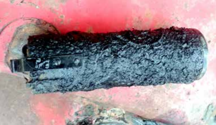
PRI MENJAVI OLJA SE DEMONTIRA STRANSKI POKROV, SITO SE IZVLEČE IN OPERE.
