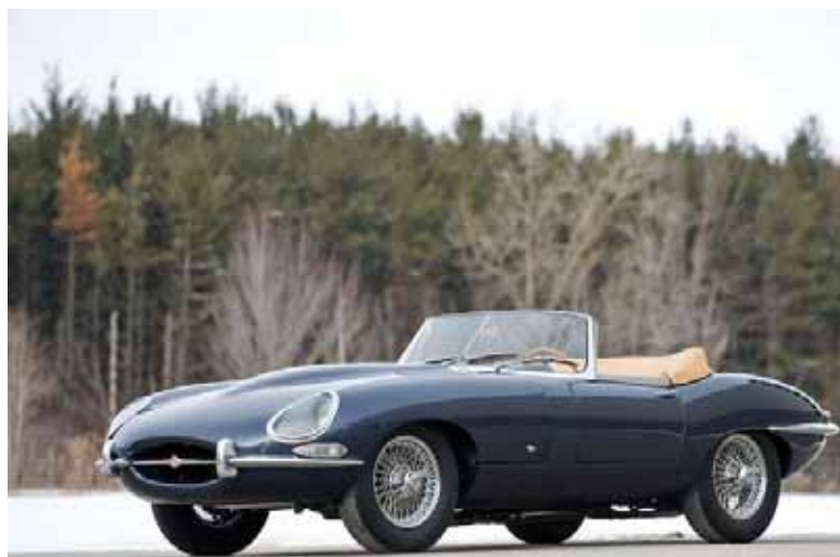
Jaguar E-type OTS – 1961, serija 1 - flatfloor, z zunaj ležečimi sponami za pokrov motorja
