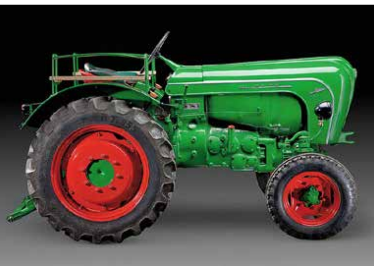
ALLGAIER A 133, 1952, POKROV MOTORJA IZ PLASTIČNEGA MATERIALA
