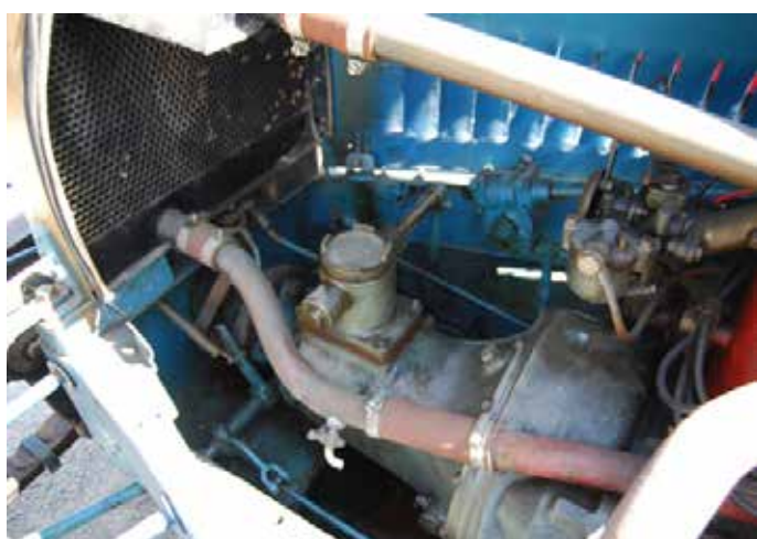
Menjalnik s kratkim kardanom, Lambert type TA "Sans Choc", 1931
