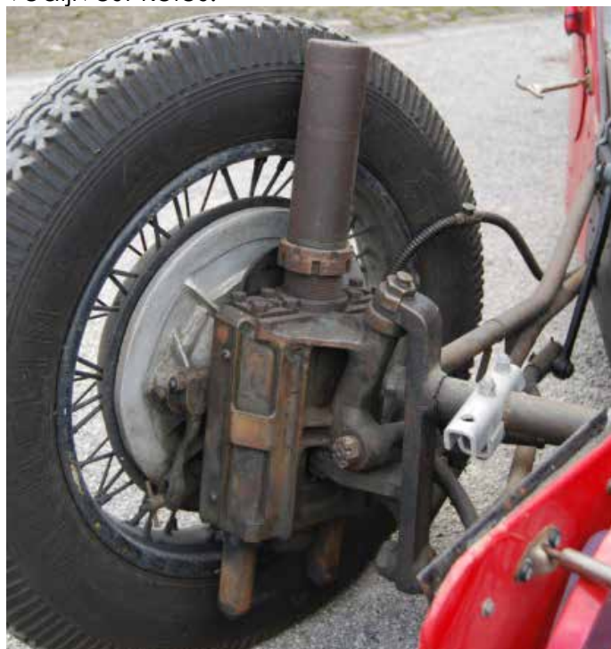
Lambert Berlinette CS 1100, 1948, sprednje vzmetenje z nastavljivim hidravličnim blažilnikom
