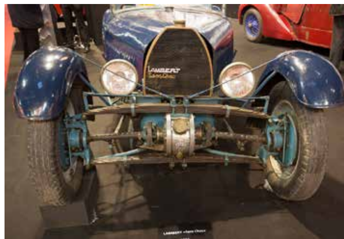
Lambert type TA "Sans Choc", 1931, diferencial s posamičnim vpetjem koles spredaj
