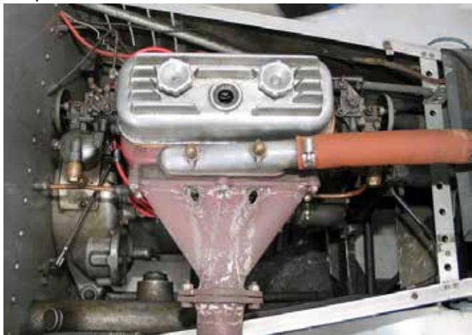
Lambert dirkalnik za Bol d'Or, 1949, motor Ruby z dvema uplinjačema
