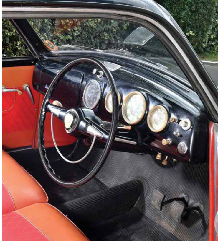
V SREDINI ARMATURNE PLOŠČE LAHKO OPAZIMO DODATEN VELIK ŠTEVEC ZA PRIKAZOVANJE VRTLJAJEV MOTORJA (VIR: RM AUCTIONS )
