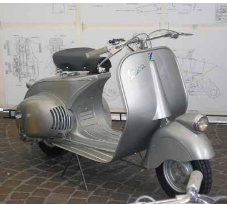
Prototip Vespe MP6 – motor 98 ccm, še brez turbine za prisilno hlajenje
