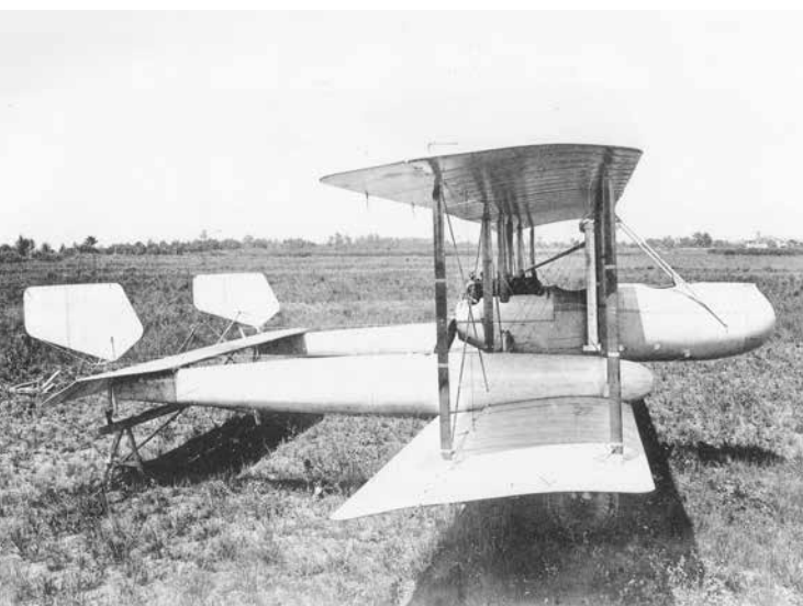
SLIKA 7. LETALO CAPRONI CA 38. KLJUB NEKOLIKO BOLJ AERODINAMIČNEMU TRUPU, KI JE LETALU OMOGOČIL HITROST DO 170 KM/H, TUDI MODEL CA 38 NI NIKOLI PRIŠEL V SERIJSKO PROIZVODNJO. PO VOJNI JE BILO UPORABLJENO V LETALSKI ŠOLI CAPRONI V VIZZOLA TICINO
