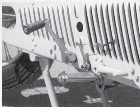
Ročica zaganjalnika in priključek za sklopko.
