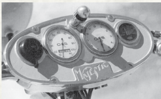
Nadzorna plošča na krmilu s tahometrom, uro, voltmetrom, signalizacijo delovanja motorja in svetilko za osvetlitev nadzorne plošče.
