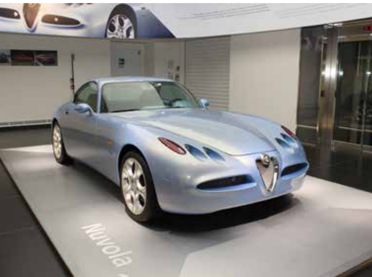
PROTOTIP NUVOLA IZ LETA 1996 Z MEHANIČNO OSNOVO ALFINEGA 6 CILINDRSKEGA AGREGATA 2492 CC DELOVNE PROSTORNINE.
