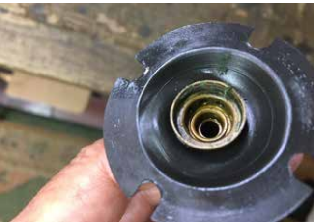
SLIKA 4. OSTANEK ETANOLA NA OPNI ŠOBE.
