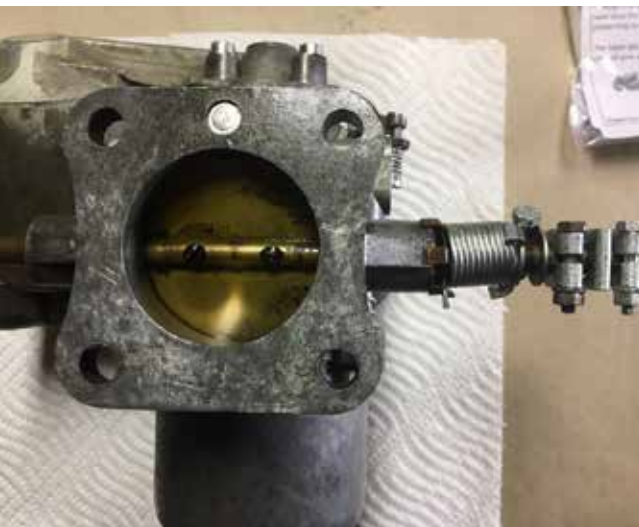
SLIKA 6. LOPUTA Z OBRABLJENO OSJO LEVEGA UPLINJAČA PRED DEMONTAŽO.
