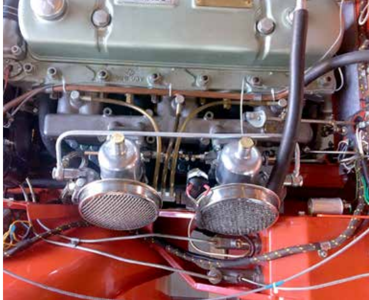
SLIKA 11. OBNOVLJENI UPLINJAČI SKUPAJ Z ZRAČNIMI FILTRI, KOT JIH JE PREDPISAL PROIZVAJALEC TEGA VOZILA.
