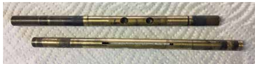
SLIKA 7. OBRABLJENOST OBEH OSI JE EVIDENTNA.
