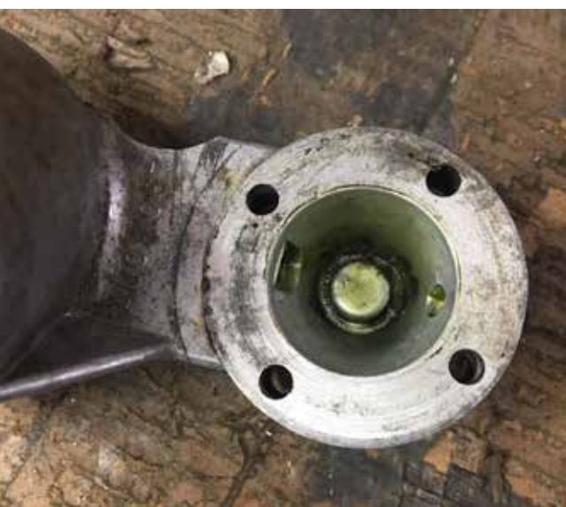
SLIKA 5. OSTANEK ETANOLA V DOVODNEM KANALU GORIVA V ŠOBO ENEGA OD OBEH UPLINJAČEV.
