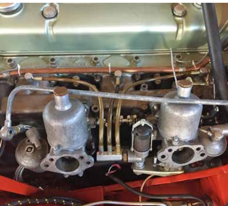
SLIKA 2. SESALNI KOLEKTOR JE DIREKTNO POVEZAN S POMOŽNIM UPLINJAČEM PREKO TREH PVC CEVI. SLIKA JE NASTALA PRED DEMONTAŽO OBEH UPLINJAČEV.
