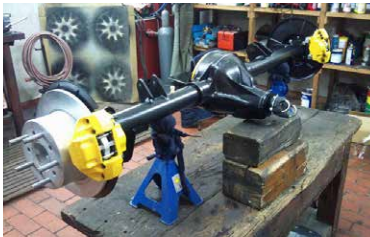
SLIKA 20 IN 21: ZADNJA PREMA IN AGREGAT MANTE 400 V FAZI OBNOVE (FOTO: DEJAN)
