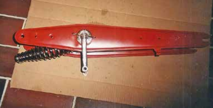
POPRAVLJENE SPREDNJE VILICE Z VZMETJO IN BLAŽILNIKOMA
