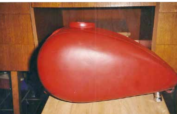
POPRAVLJENA POSODA ZA GORIVA, PRIPRAVLJENA ZA BARVANJE
