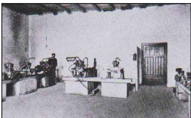
Puhova postaja za preizkušanje motorjev avtomobilov in motociklov ter dinamometer za merjenje njihove moči.
