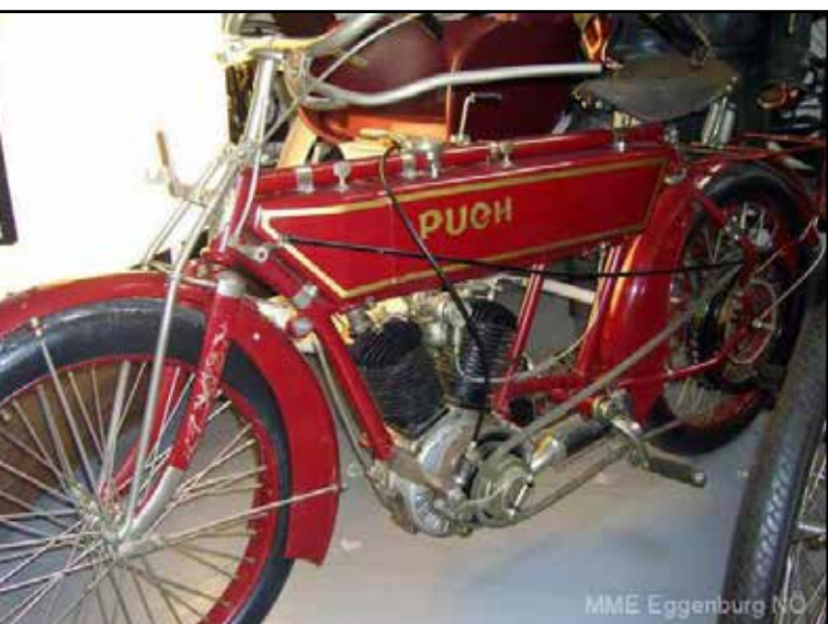
5/6 HP z bočno prikolico 6 KM pri 3000U/min, dva valja na V, 900 ccm.
