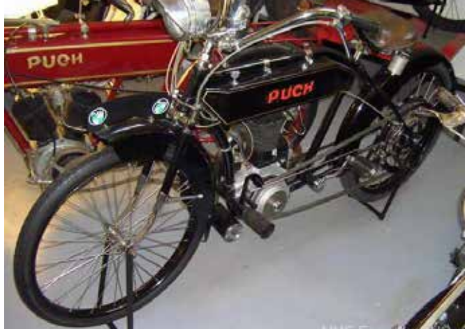
Puch R 2, 1914. 2,5 KM pri 3000U/min, en valj, štirje takti, 308 ccm.
