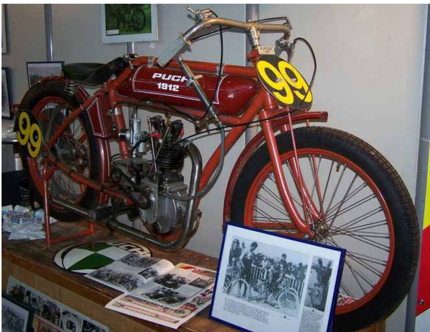
Puhova dirkalna različica motorja. Eno valjni štiritaktni motor prostornine 274 ccm tehta le 52 kg.
