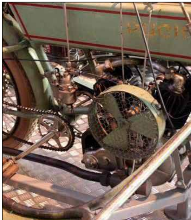
Pogled na stranski ventilator
