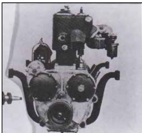
Štirivaljni motor 28/32 HP, 1909. Zgoraj s strani uplinjača, spodaj sta razdelilca vžiga.
