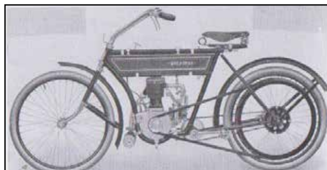
Eno valjni Puch 31/2 HP, tip N s teleskopsko prednjo in teleskopsko vzmeteno zadnjo vilico. Leta 1912 novo na trgu. R1, prvi na svetu s teleskopsko vilico.
