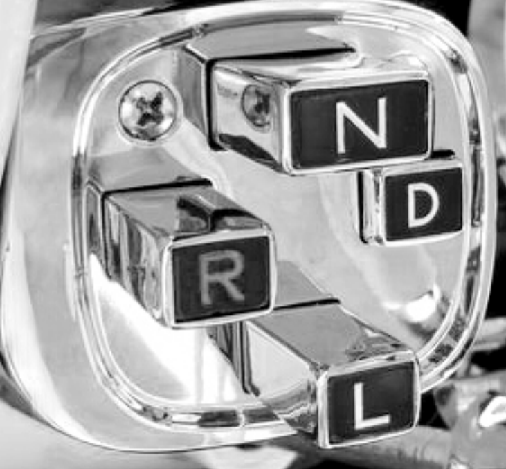
SLIKA 10: GUMBI ZA OPRAVLJANJE NA VOLANU DVOSTOPENJSKEGA POWERFLITE AVTOMATSKEGA MENJALNIKA NA CHRYSLER NORSEMANU (VIR. URL: HTTPS://IT.WIKIPEDIA.ORG/WIKI/CHRYSLER_NORSEMAN - 30. 6. 2018)
