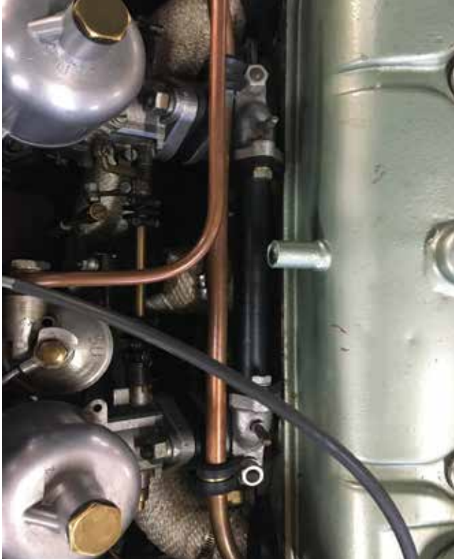
IZOLATOR MED SESALNIMA KOLEKTORJEMA IN UPLINJAČEMA UPOČASNI SEGREVANJE BENCINA V UPLINJAČIH
