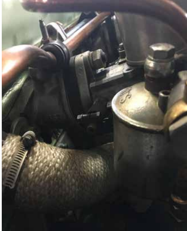
IZOLACIJA IZPUŠNEGA KOLEKTORJA ZMANJŠA PRENOS TOPLOTE NA UPLINJAČA
