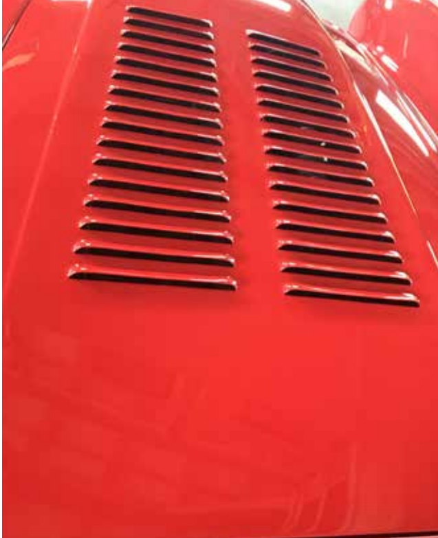
ZA BOLJŠI IZSTOP VROČEGA ZRAKA SKRBIJO ZRAČNE REŽE NA POKROVU MOTORJA
