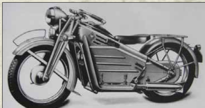
Motorno kolo znamke VICTORIA KR 8 letnik 1934-35 in KR 9 letnik 1936-37, pri obeh prostornina 500 ccm, moč 16 PS, razlika je bila samo v motorju. KR 9 je imel močnejši motor.
