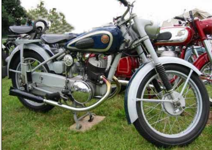
Motorno kolo VICTORIA KR 25 HM Aero letnik 1951-53, dvo taktni, prostornina 247 ccm, 10,5 PS, štiri prestave
