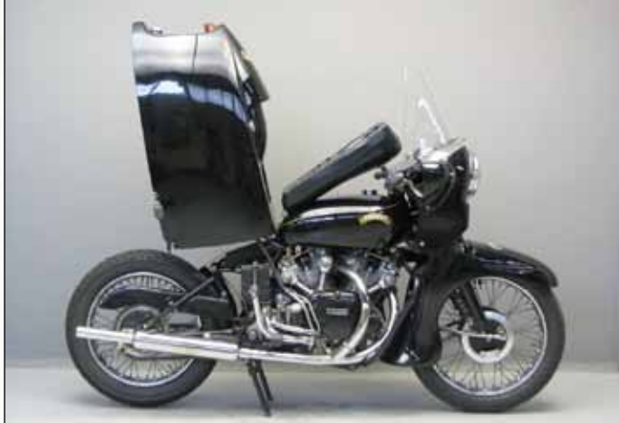
Vincent Black Prince z delno odstranjenim oklepom in dvignjenim zadnjim delom
