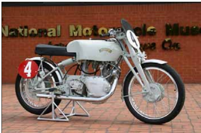
Vincent Series C Grey Flash, 1948, na zadnjem kolesu montirana zobnika na obeh straneh
