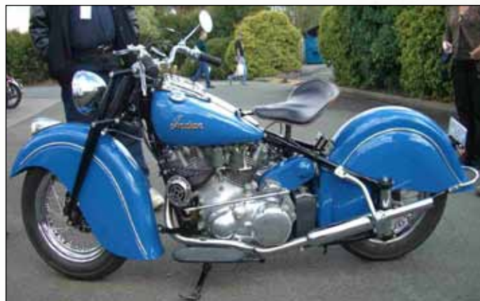
Vindian, 1950, hibrid z okvirjem Indian in motorjem Vincent
