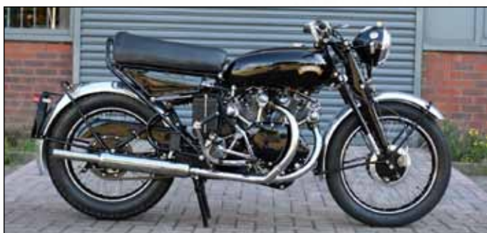
Vincent Series D Black Shadow, 1954, dodan pomožni nosilni okvir za sedež
