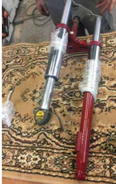
VILICE PRED OBNOVO IN OBNOVLJENE VILICE
